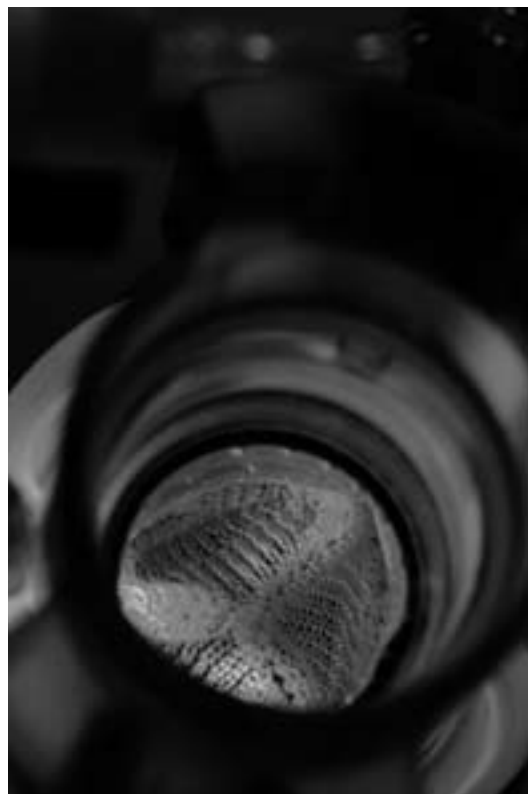
foto: gebreide aortaklep scaffold in een bioreaktor. (foto Bart van Overbeeke)
